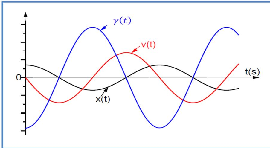
Figure 14: Le mouvement rectiligne sinusoïdal
