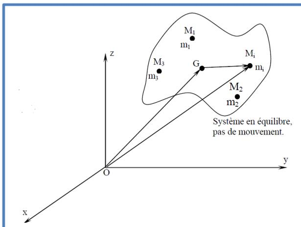
Figure 36 : Centre d'inertie d'un système de masse
