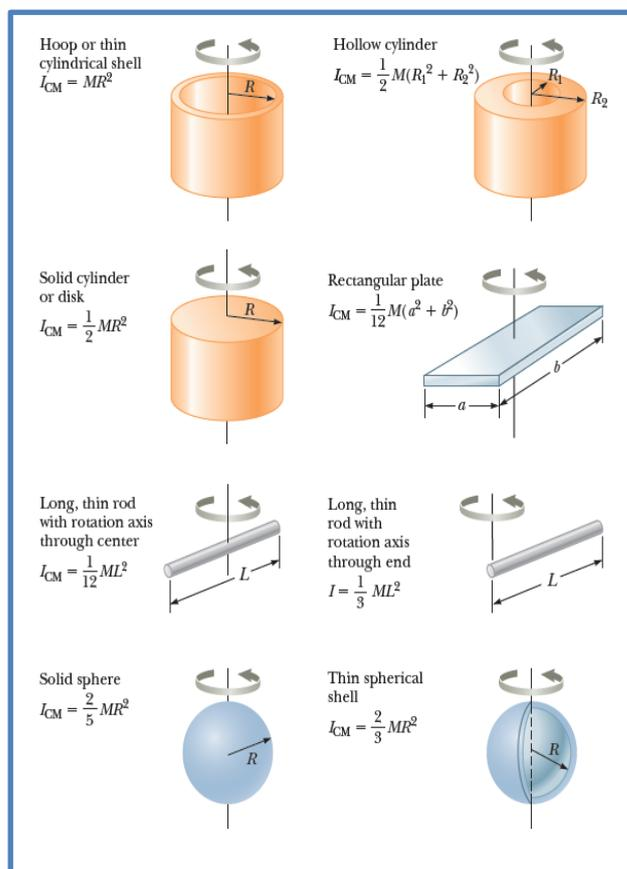
Figure 37 : Les moment d'inertie des différent forme
