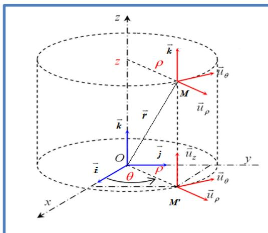
Figure 8: Système cylindrique
