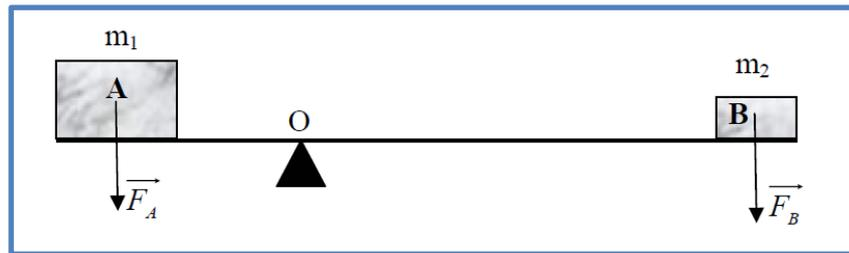
Figure 35 : Centre d'inertie entre deux masses
