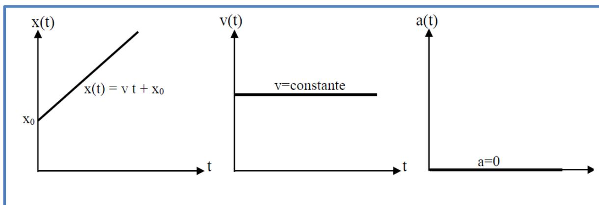
Figure 12: Le mouvement rectiligne uniforme
